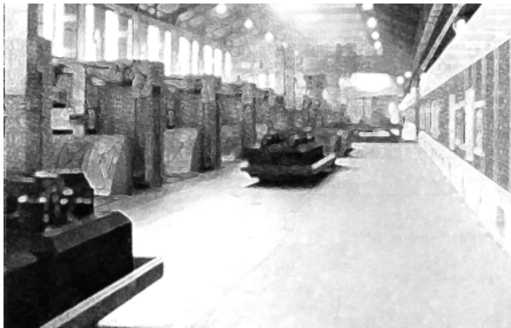
Figura 2 – Ilustração de um potroom . À esquerda, os fornos; à direita, os terminais de controlo informático; ao centro, ânodos esperando substituir os que se encontram desgastados.
